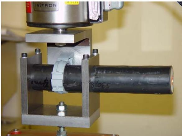
Abb. 4: Statischer Bruchtest, Prüfmachine Instron, ohne vorherige Ermüdung, Probe 3
