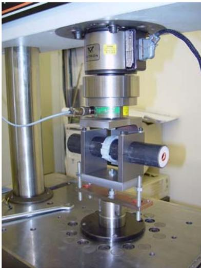
Abb. 2: Ermüdungstest in der Prüfmachine Instron, Probe 1
