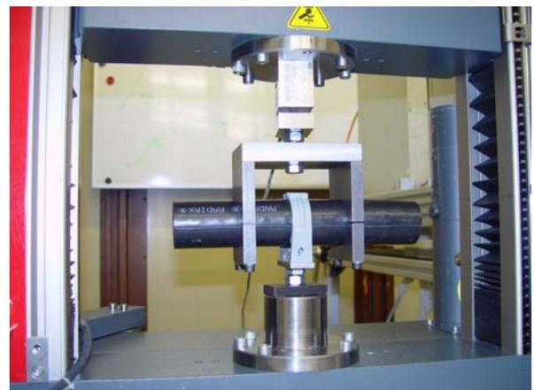
Abb. 7: Statischer Bruchtest, Rohrschelle um 90° versetzt, nach vorheriger Ermüdung, Probe 2
